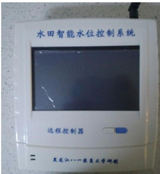
水田智能水位控制系统---远程控制器
